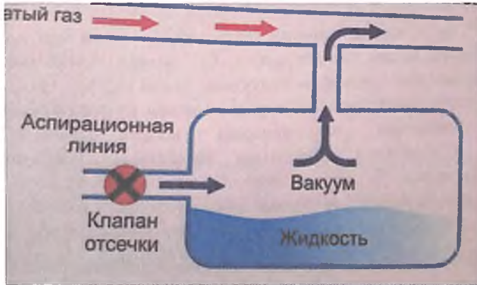
Расм 2.4. Вентури насос схемаси
