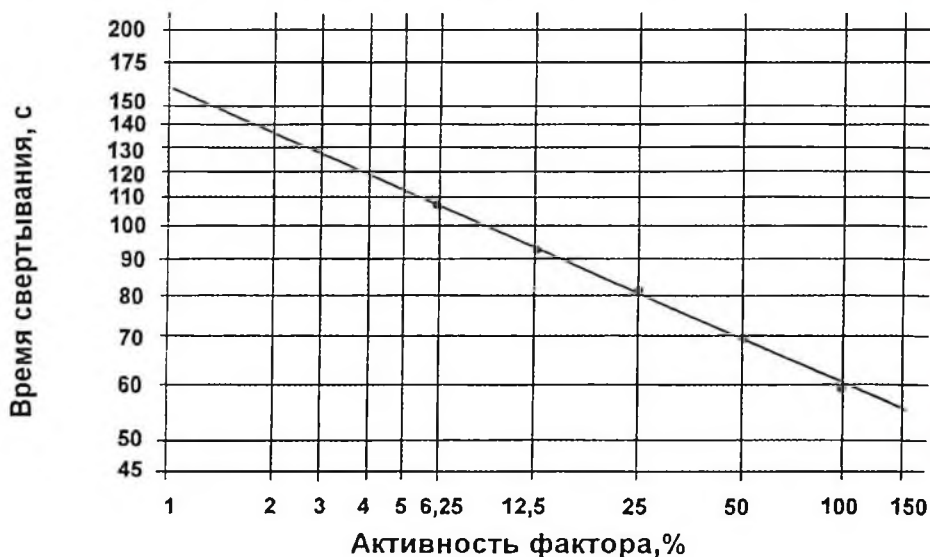
Рис. 12. Система координат и пример построения калибровочной кривой для определения фактора VIII или IX.
