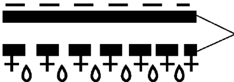
25.10.Схема сушки методом электроосмоса
