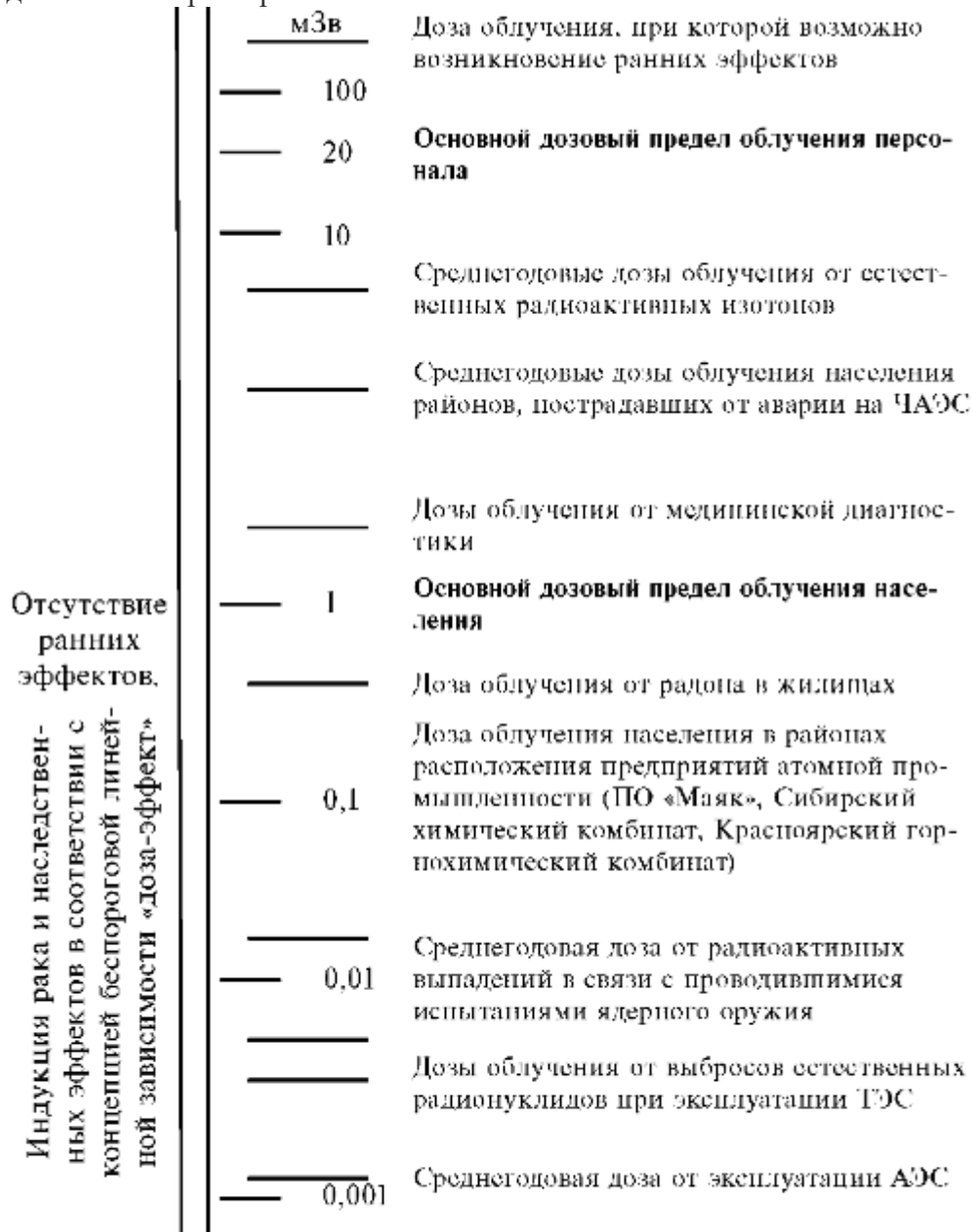
Схема 6.1. Сравнительная шкала доз облучения населения стран СНГ, рекомендуемых дозовых пределов, а также эффектов ионизирующего излучения
