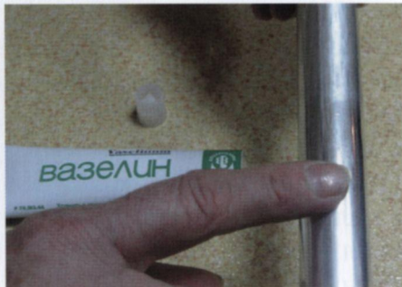
Рис. 76. Алюминиевый картридж смазывается вазелином.
