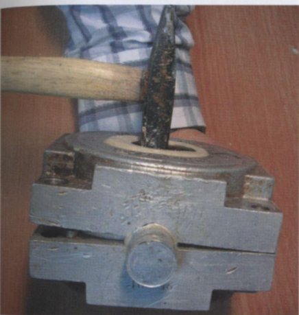
Рис. 80. Извлечение гипсовой формы из кюветы.
