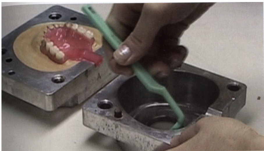
Рис. 39. Подготовка второй половины кюветы.
