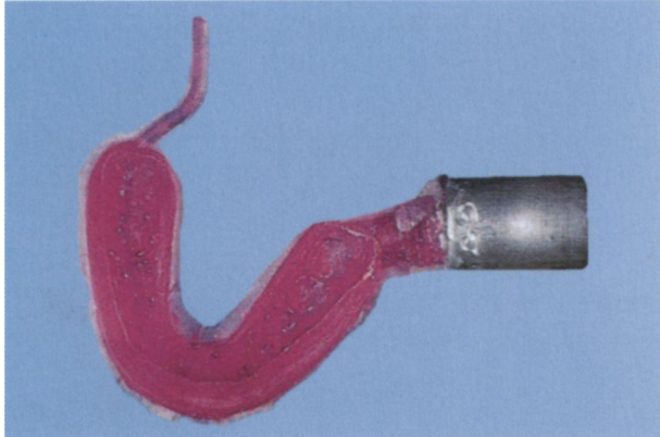
Рис. 133. Отлитый позиционер с литьевыми каналами.
