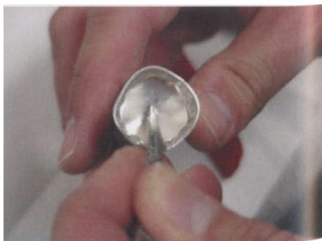
Рис. 74. Нанесение насечек на крышке картриджа.
