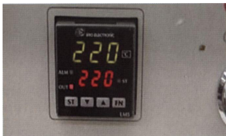
Рис. 77. Световое табло инъекционной машины с установленной температурой.
