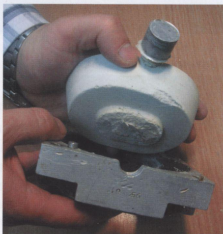
Рис. 80. Извлечение гипсовой формы из кюветы.
