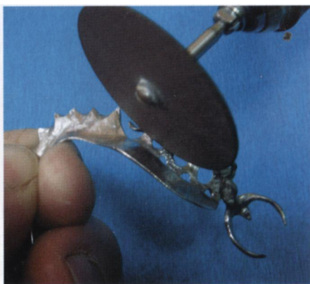
Рис. 61. Истончение металла в месте соединения с термопластом.
