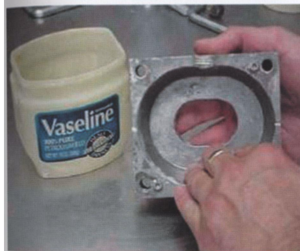
Рис. 65. Обработка внутренней поверхности кюветы вазелином.
