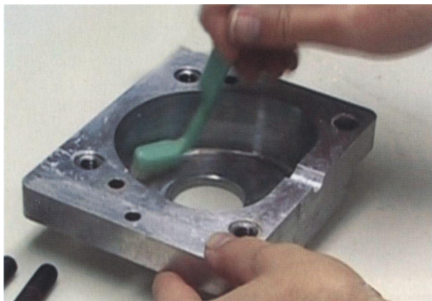
Рис. 35. Нанесение вазелина на основание кюветы.
