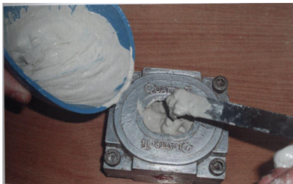
Рис. 70. Заливка кюветы гипсом.
