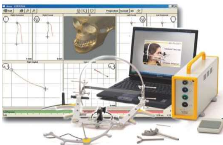
Рис. 9.14. Электронный аксиограф для регистрации функции височно-нижнечелюстного сустава
