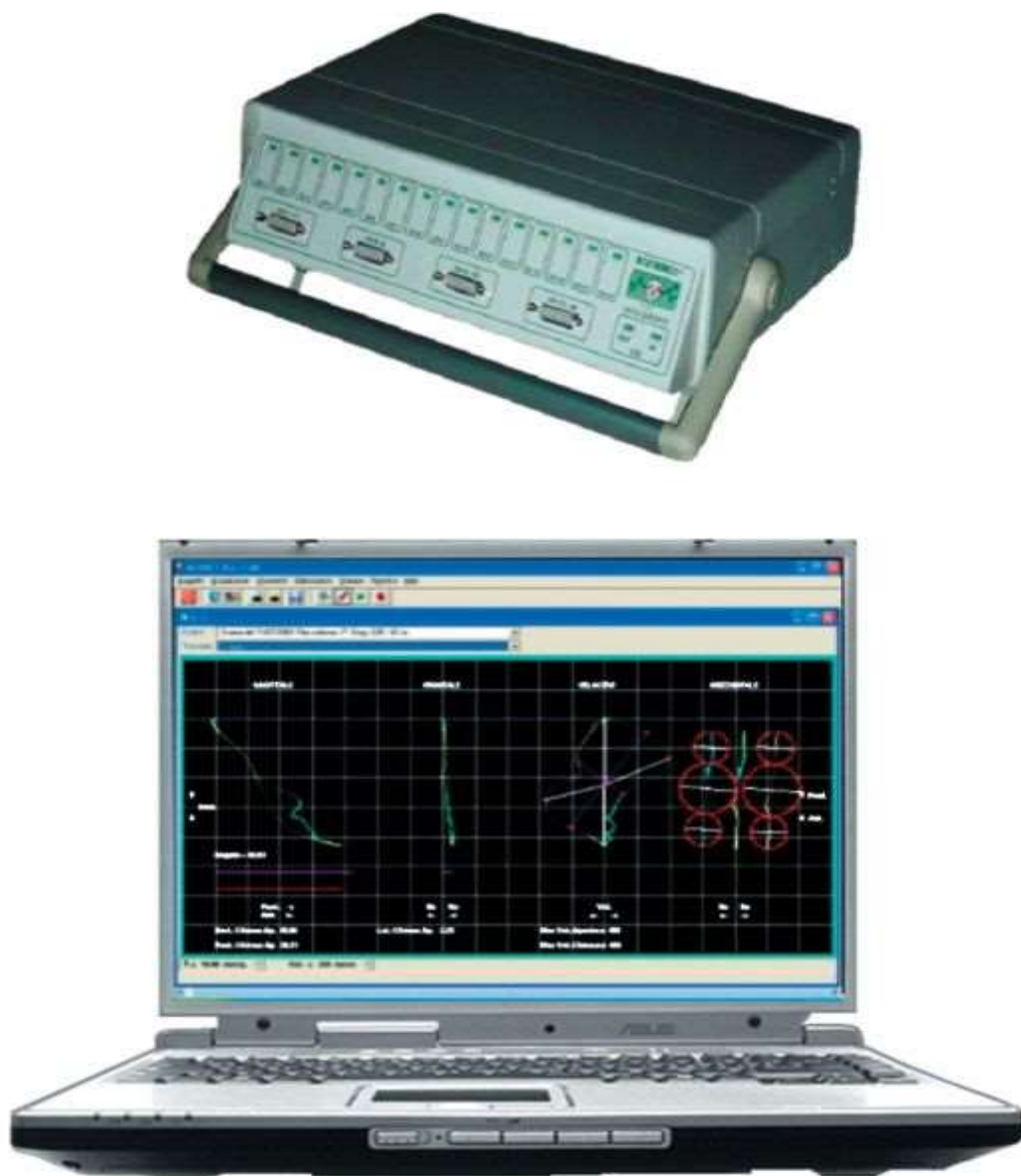
Рис. 9.1. Многоканальный электромиограф фирмы «Биотроник» (Италия) и регистрация электромиограмм мышц челюстно-лицевой области в программе KEY-NET
