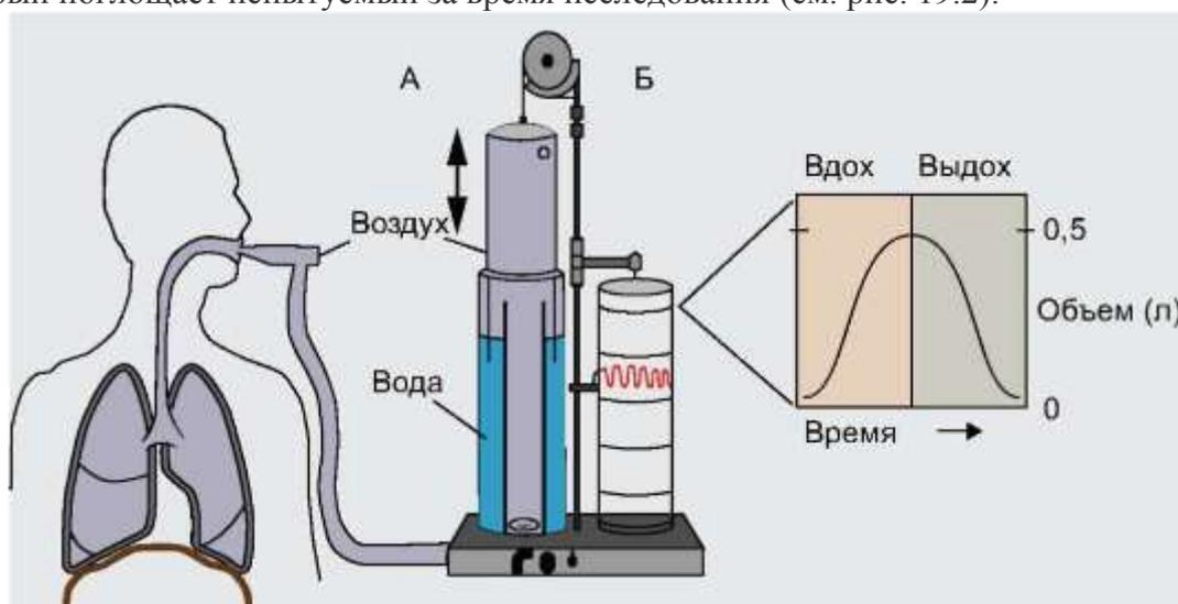
Рис. 19.2. Схема работы водяного спирометра (А). Спирография (Б)
