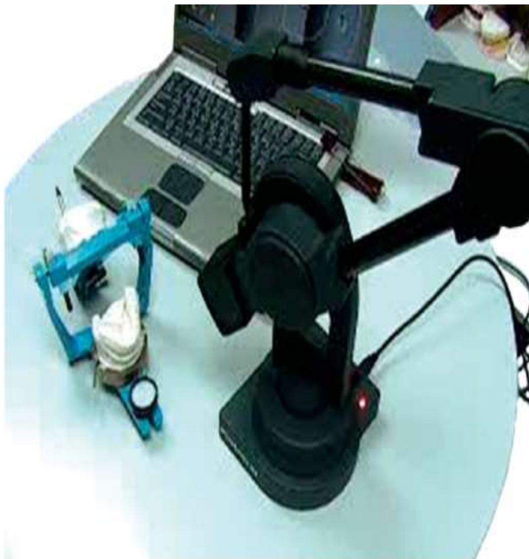
Рис. 8.29. Трехмерный анализ гипсовых моделей зубных рядов в артикуляторе с использованием компьютерной программы
