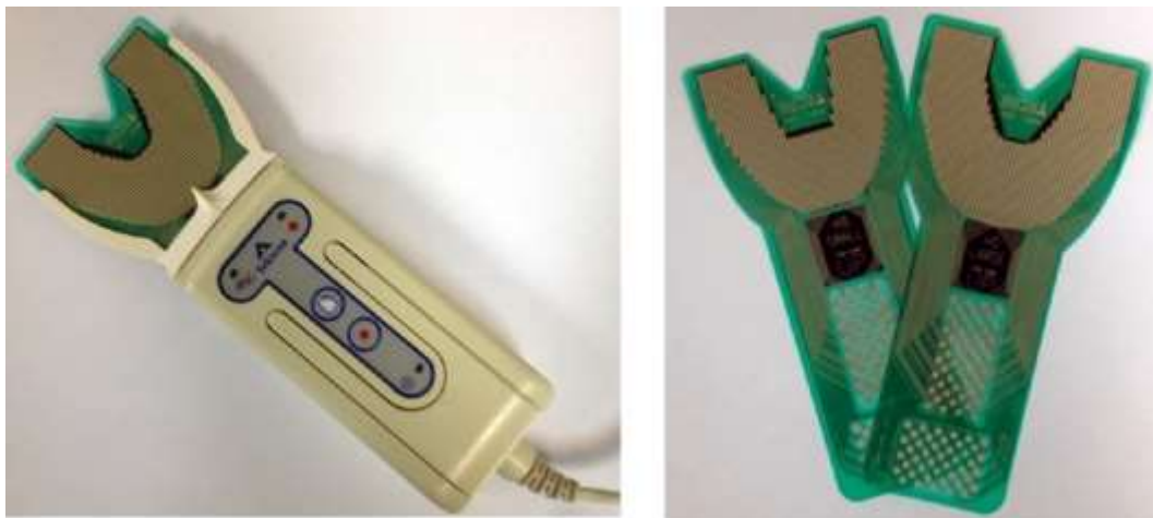
Рис. 6.6. Рукоятка прибора и сенсорные датчики
