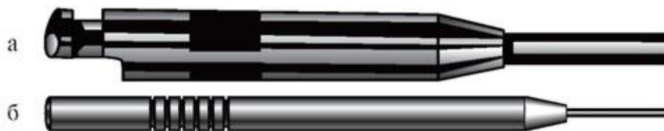
Рис. 2.7. Кодирование инструментов полоской (а), кольцами (б)
