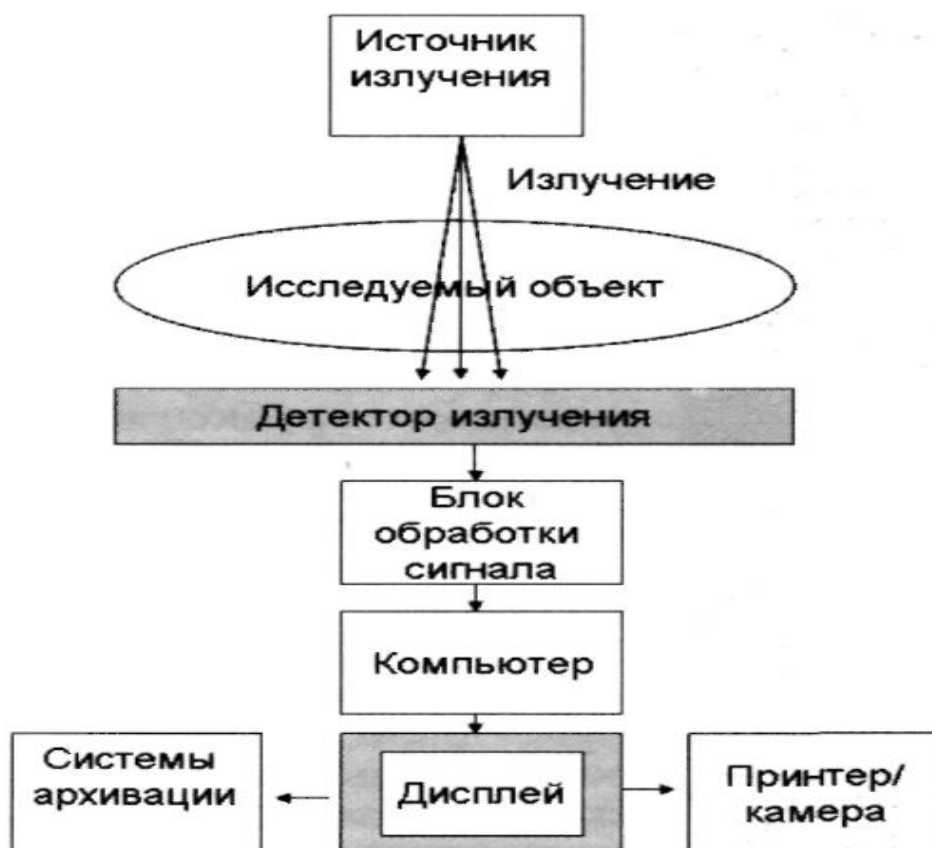
Рис. 3.2. Принципиальная схема устройства аппаратов для получения лучевых изображений.
