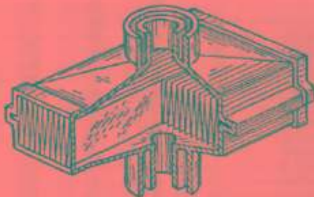
Рис. 6.23 Устройство гидрофобного комбинированного антистатического фильтра с полипропиленовой сеткой.
