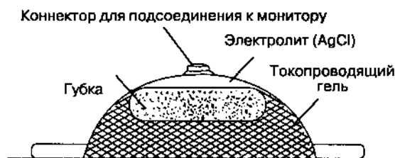
Рис. 6-17. Поперечный разрез хлорсеребряного электрода
