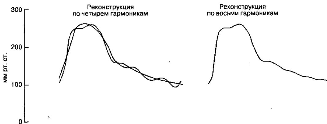
Рис. 6-13. На этих иллюстрациях представлено совмещение исходной пульсовой волны с реконструкциями, полученными с помощью анализа Фурье: слева реконструкция воспроизведена по четырем гармоникам, справа — по восьми. Следует отметить, что чем больше число гармоник, тем точнее реконструкция соответствует исходной волне. (Из: Saidman L. S., Smith W. T. Monitoring in Anesthesia. Butterworths, 1984. Воспроизведено с разрешения.)
