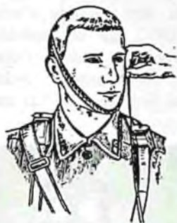
24-rasm. Shlem-niqobni tanlashda boshni vertikal aylana bo'ylab o'lchash usuli.
