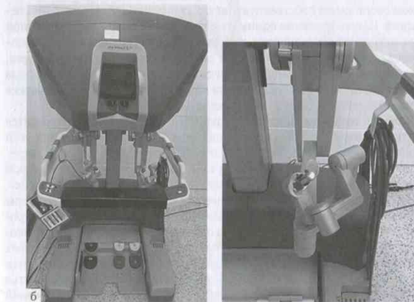
Рис. 16-14. Роботический хирургический комплекс da Vinci: а — ножные педали и джойстики консоли хирурга da Vinci S; б — ножные педали и джойстики консоли хирурга da Vinci Si
