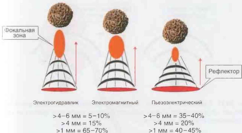
Рис. 10.9. Различные принципы генерации ударно-волновых импульсов и их характеристики. Степень фрагментации на них камня до 0,2 см
