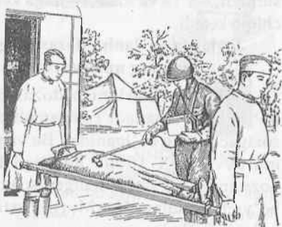
21-rasm. Kishilarning radioaktiv moddalar bilan zararlaniish darajasini DP-5V asbobi yordamida aniqlash.
