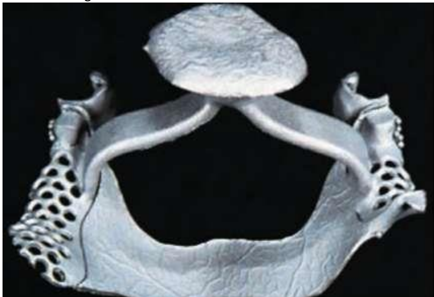
Рис. 10.16. Отлитый необработанный каркас
