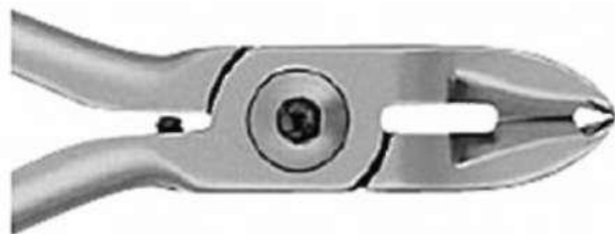
Рис. 3.375. Кусачки для разрезания бандажных колец
