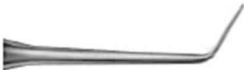
Рис. 3.90. Гладилка, изогнутая по плоскости
