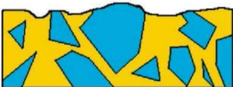
Рис. 8.42. Неравномерность полирования пломбы из макронаполненных композитов
