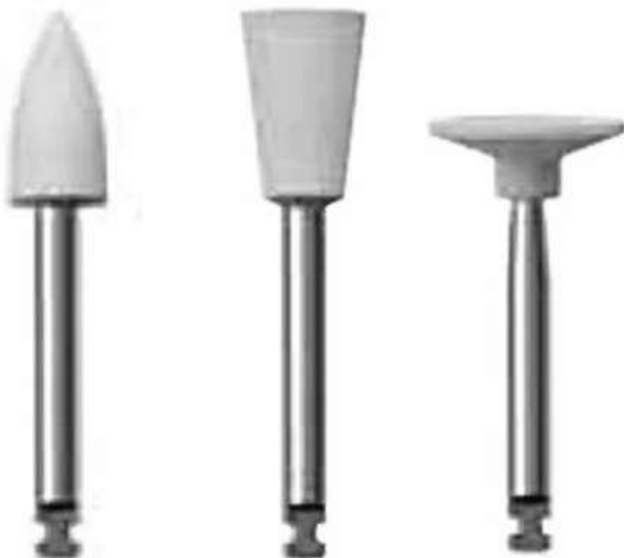
Рис. 3.382. Полирующие инструменты с алмазной насыпкой
