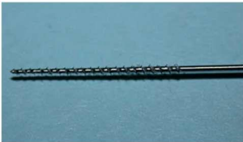
Рис. 3.476. Рашпиль «крысиный хвост» (рабочая часть)
