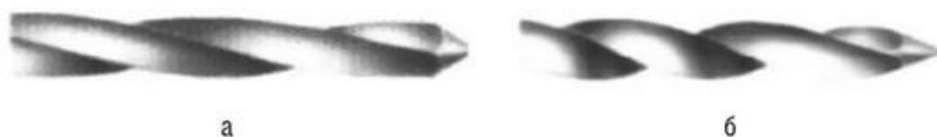
Рис. 7.22. Инструменты, изготовленные методом скручивания: а - К-ример; б - К-файл Инструменты, изготовленные методом фрезерования (рис. 7.23):
