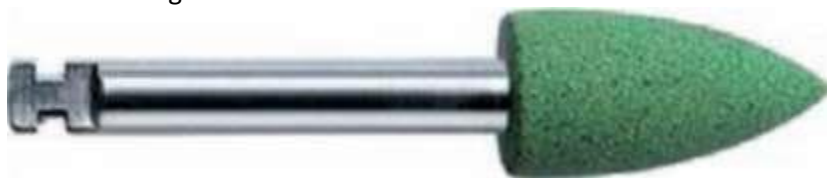
Рис. 3.391. Инструменты с песчаной насыпкой
