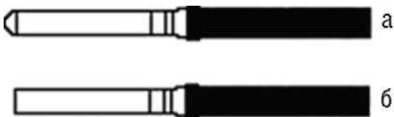
Рис. 3.410. Инструменты с закругленной (а) и плоской (б) торцевой частью хвостовика
