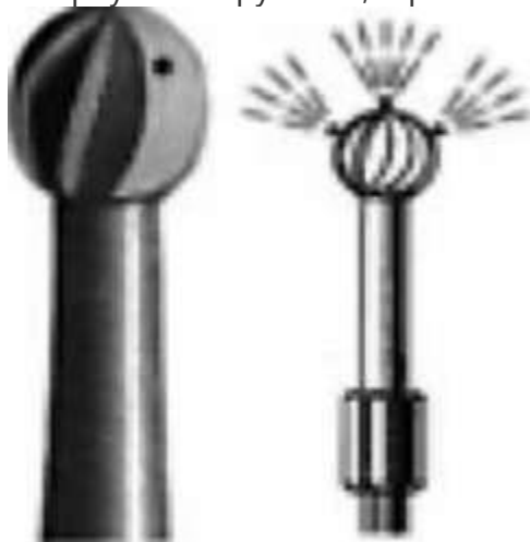
Рис. 3.388. Стальной бор с внутренней системой охлаждения
