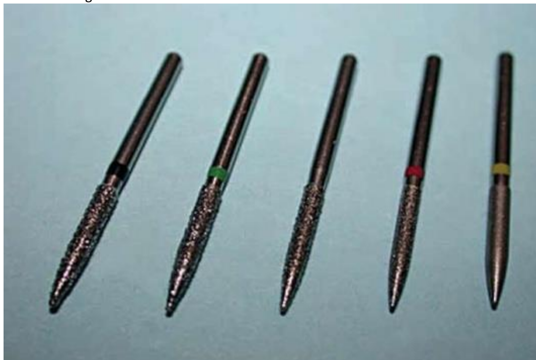
Рис. 3.418. Цветовое кодирование алмазных инструментов
