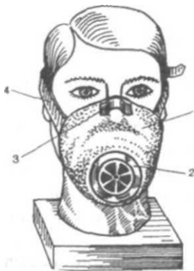
39-rasm. R-2 respiratori: 1 - yarim niqob; 2 - nafasni chiqaruvchi klapan; 3 - burun qisqichi; 4 - rezinadan tayyor-langani egiluvchan tasma.
