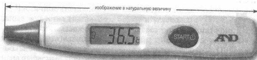
Рис. 5-2. Термометр для мгновенного измерения температуры тела.
