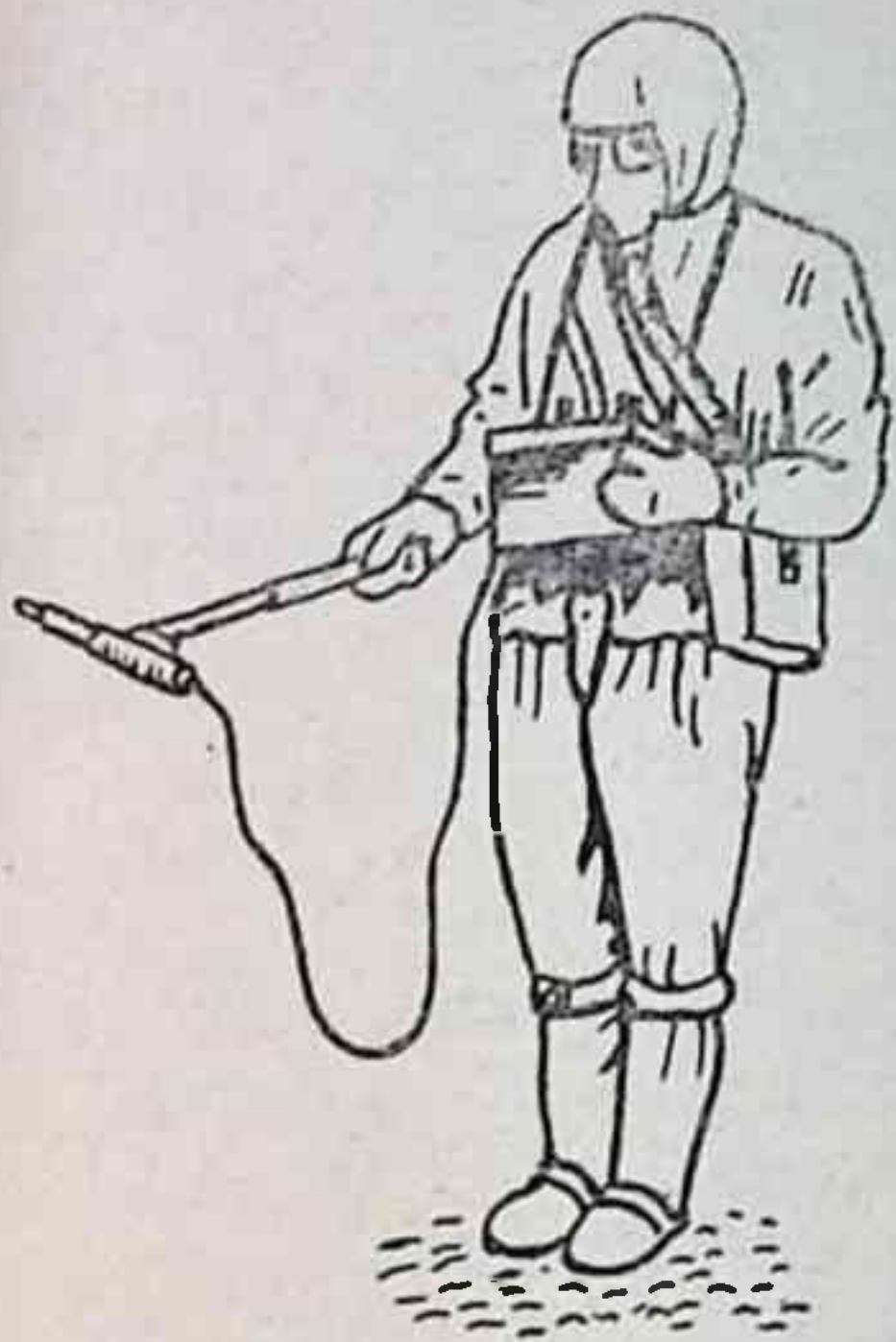
Рис. 48. Измерение уровня радиации на зараженной местности прибором ДП-5В.
