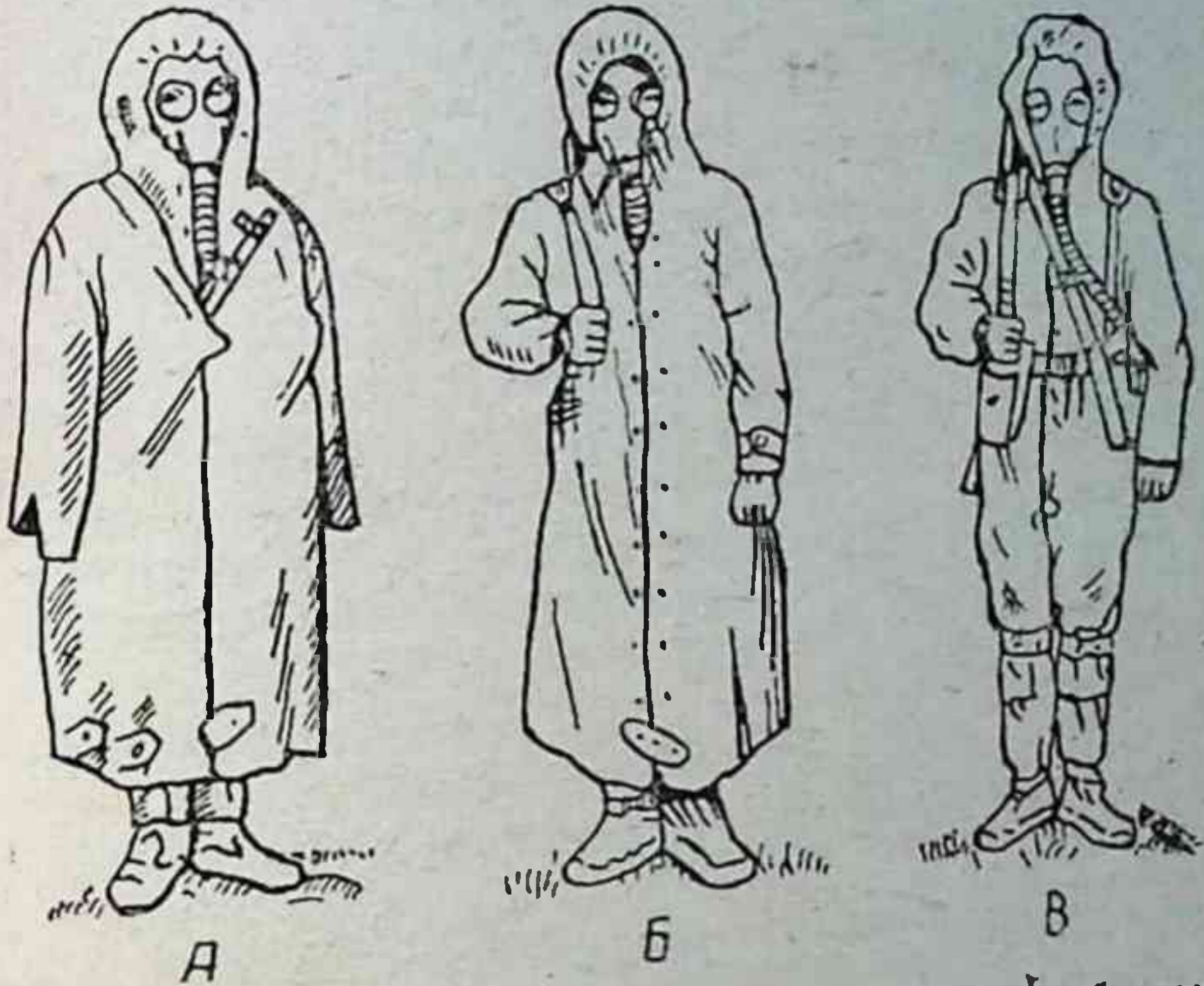
Рис. 68. Общевойсковой защитный комплект в боевом положении:
