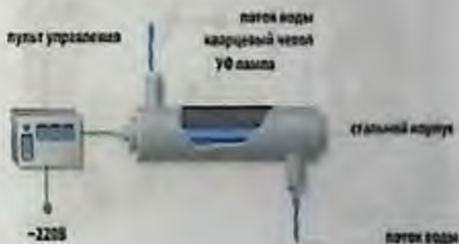
УЛЬТРАФИОЛЕТОВОЕ ОБЕЗЗАРАЖИВАНИЕ ВОДЫ
