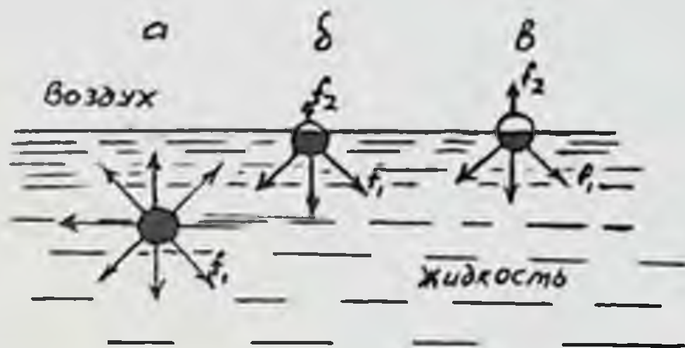
Рис.7.1. Схема образования поверхностных сил. В объёме жидкости молекулярные силы скомпенсированы, на поверхности свободны.
