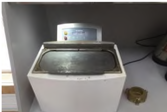
Расм-2.5 Иссиқ қотиб қоладиган пластмассалар учун автоматик иссиқ қотиш ваннаси
