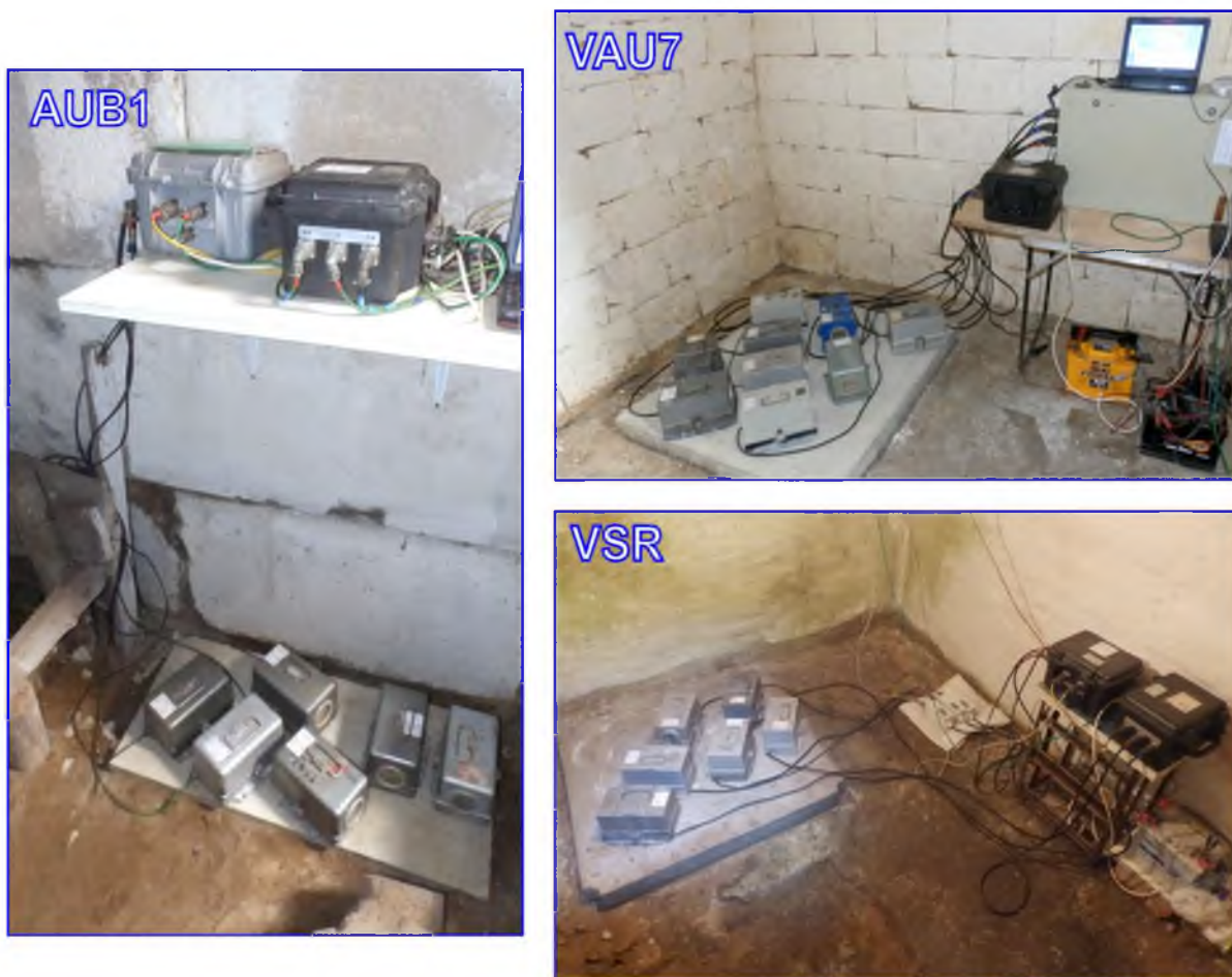
Рис. 2. Проведение тестирования оборудования на сейсмических станциях локальной сети ( AUB1 - Каменно-Верховка; VAU7 - Архангельское; VSR - Сторожевое)
