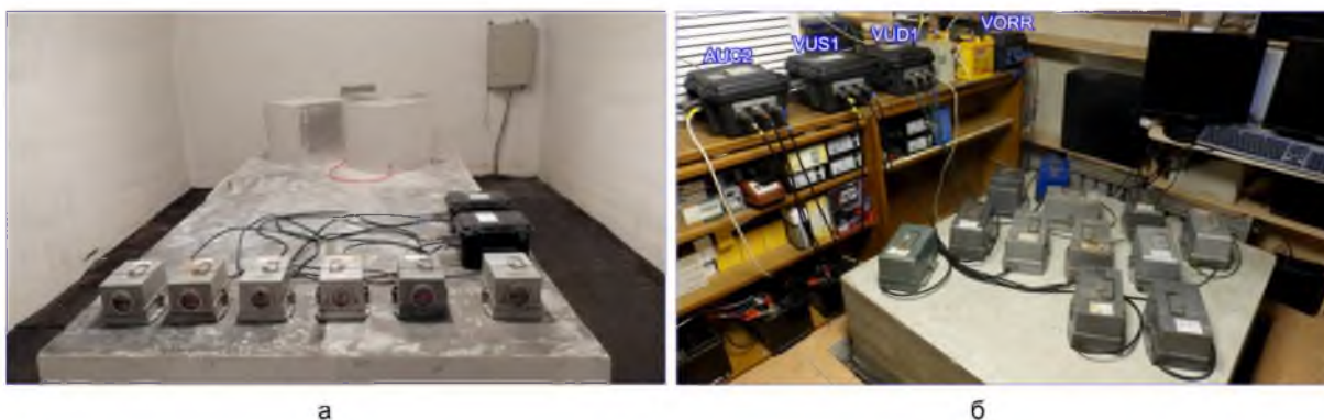
Рис. 1. Тестирование оборудования в шахте г. Обнинска на постаменте сейсмостанции OBN тестового комплекта (а) и в подвале на постаменте сейсмостанции VORR (б) двух новых комплектов с тестовым комплектом (AUC2) и сейсмостанцией Воронеж (VORR)
