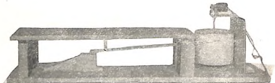
Рис. 10. Динамограф для непосредственной записи изменений усилий в течение толчка (по В. М. Абалакову).
