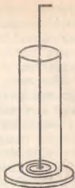
Рис. 21.1. Спиральная мешалка для получения эмульсий по методу Кремнева
