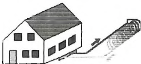
Рис. 1.6. Виды горизонтальных спиральных грунтовых теплообменников.
