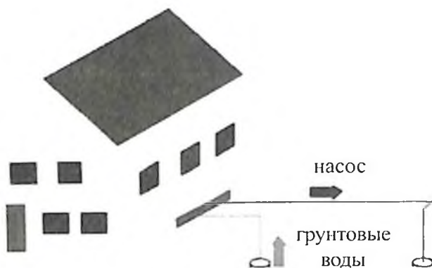
Рис. 2. Схема открытой системы сбора низкопотенциально тепловой энергии поверхностных слоев Земли.
