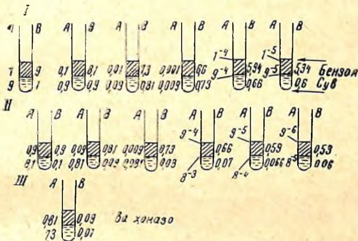
57-расм. Пробиркалардаги тақсимловчи хроматография схемаси:
