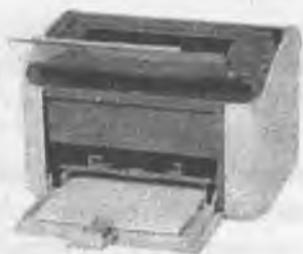
Струйные принтеры. Струйные принтеры относятся к безударным устройствам, т.к. головка печатающего устройства не касается бумаги. Для получения изображения используют чернила.
