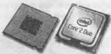
Процессор выполнен в виде сверхбольшой интегральной схемы. Он содержит большое число электронных компонентов, размещенных на маленькой кремниевой пластинке. Их число достигает нескольких миллионов. Характеристиками микропроцессора служат тактовая частота и разрядность.
