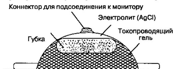
**Рис. 6-17.** Поперечный разрез хлорсеребряного электрода
