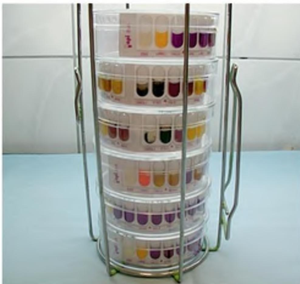
Рис. 12-2. Контейнер с тест-системами API 20An, подготовленный для помещения в анаэростат
