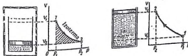
4.4-Rasm. Izotermik jarayon.
