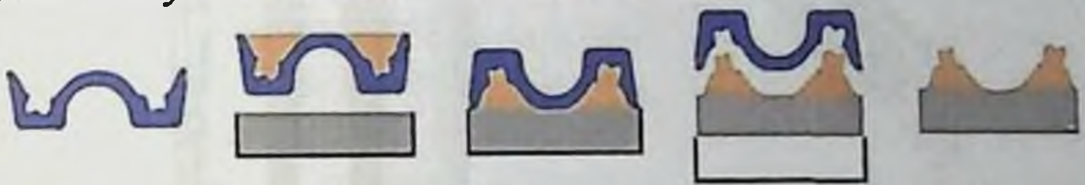
Kombinatsiyalangan modelni quyish sxemasi.
