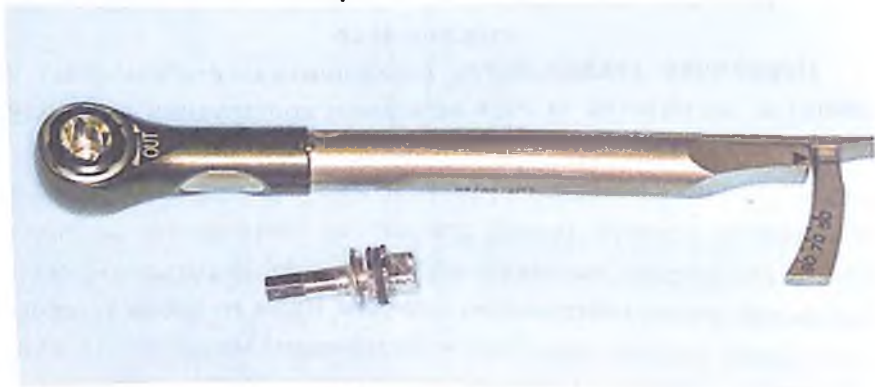
Рис. 61. Ключ-контроллер торка (динамометрический ключ). Вид ручного ключа для определения силы торка и соединения частей имплантата. Данный инструмент помогает измерять торк в диапазоне 50-90 Нсм
