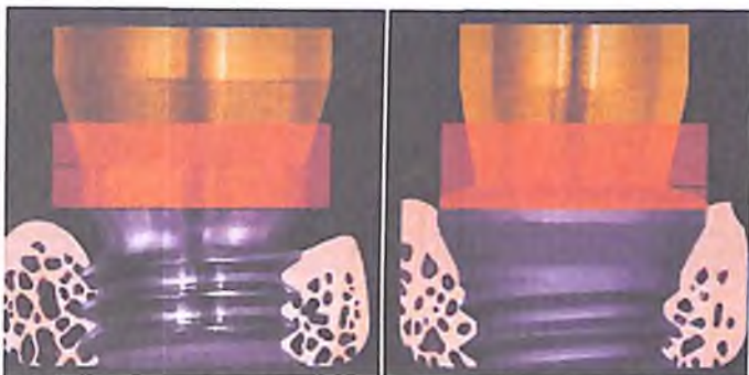
Рис. 23 Концепция “Переключение платформ-“Switch platform””: соединение имплантат-абатмент без “Switch platform”(слева); соединение имплантат-абатмент “Switch platform”(справа)
