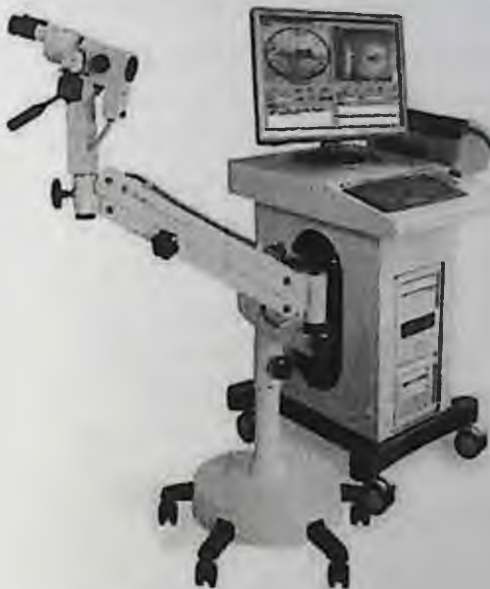
Рис. 74. Бинокулярный цифровой кольпоскоп с видеосистемой, выводящий изображение на экран монитора и позволяющий фиксировать видеоматериал и сохранять его в компьютере.
