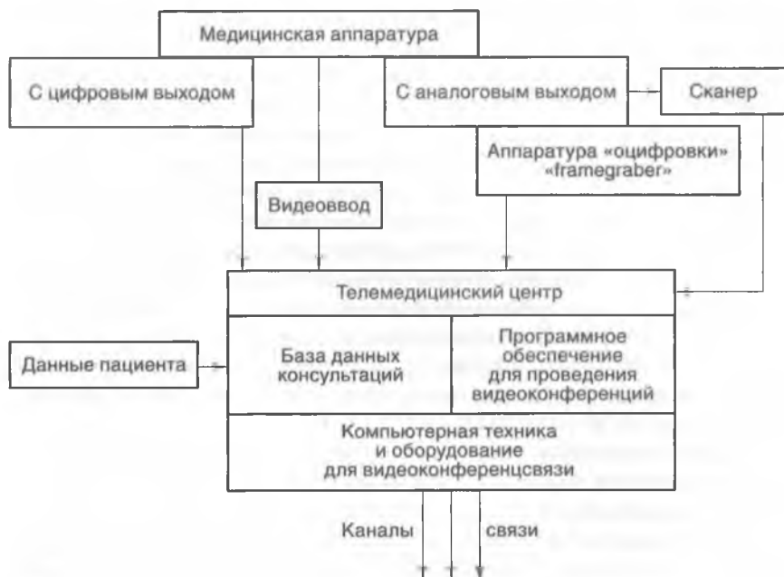
Рис. 9.2. Аппаратно-программно-коммуникационный комплекс для телемедицины
