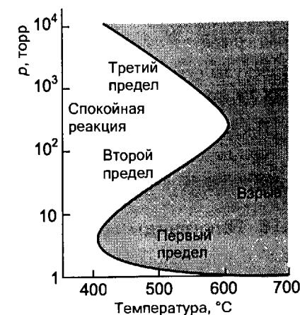
Рис. 8.12. Изменение характера реакции H_2+O_2 в зависимости от давления и температуры.
