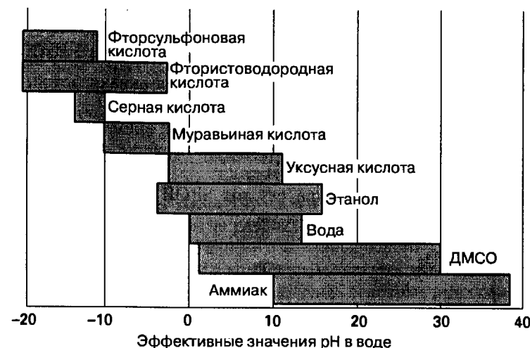
Рис. 5.2. Диапазоны различимости силы кислот и оснований в различных растворителях. В каждом случае ширина диапазона пропорциональна константе автопротолиза pK_{sol} растворителя.
