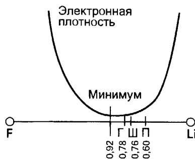
Рис. 2.21. Изменение электронной плотности вдоль оси Li-F в LiF. Точка П соответствует радиусам ионов по Полингу, Г — радиусам по Гольдшмидту (1927 г.) и Ш — по Шеннону.
