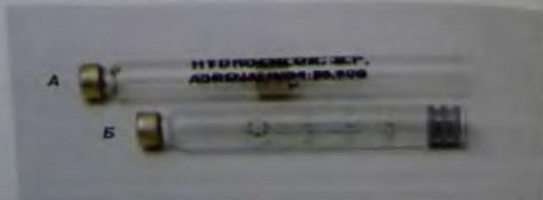
Рис. 12. Стеклоянная (А) и пластмассовая (Б) карпулы.
