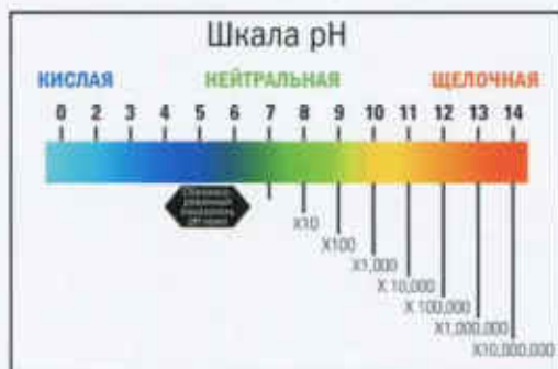
Шкала pH является логарифмической, то есть разница в одну единицу pH эквивалентна десятикратной разнице в концентрации ионов водорода
