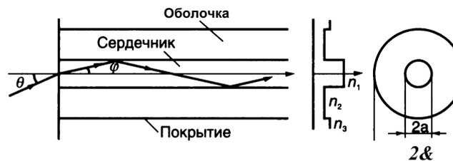
Рис. 31. Принципиальное устройство оптического волокна
