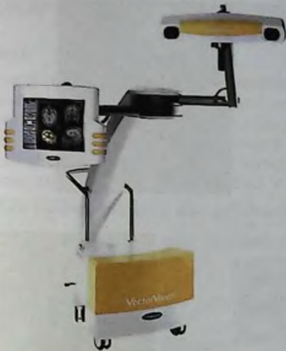
Рис. 4.6. Система нейронавигации: датчики (вверху справа) отслеживают положение инструмента в пространстве; на экране монитора в реальном времени положение инструмента в ране соотносят с данными компьютерной или магнитно-резонансной томографии в любых проекциях и объеме
