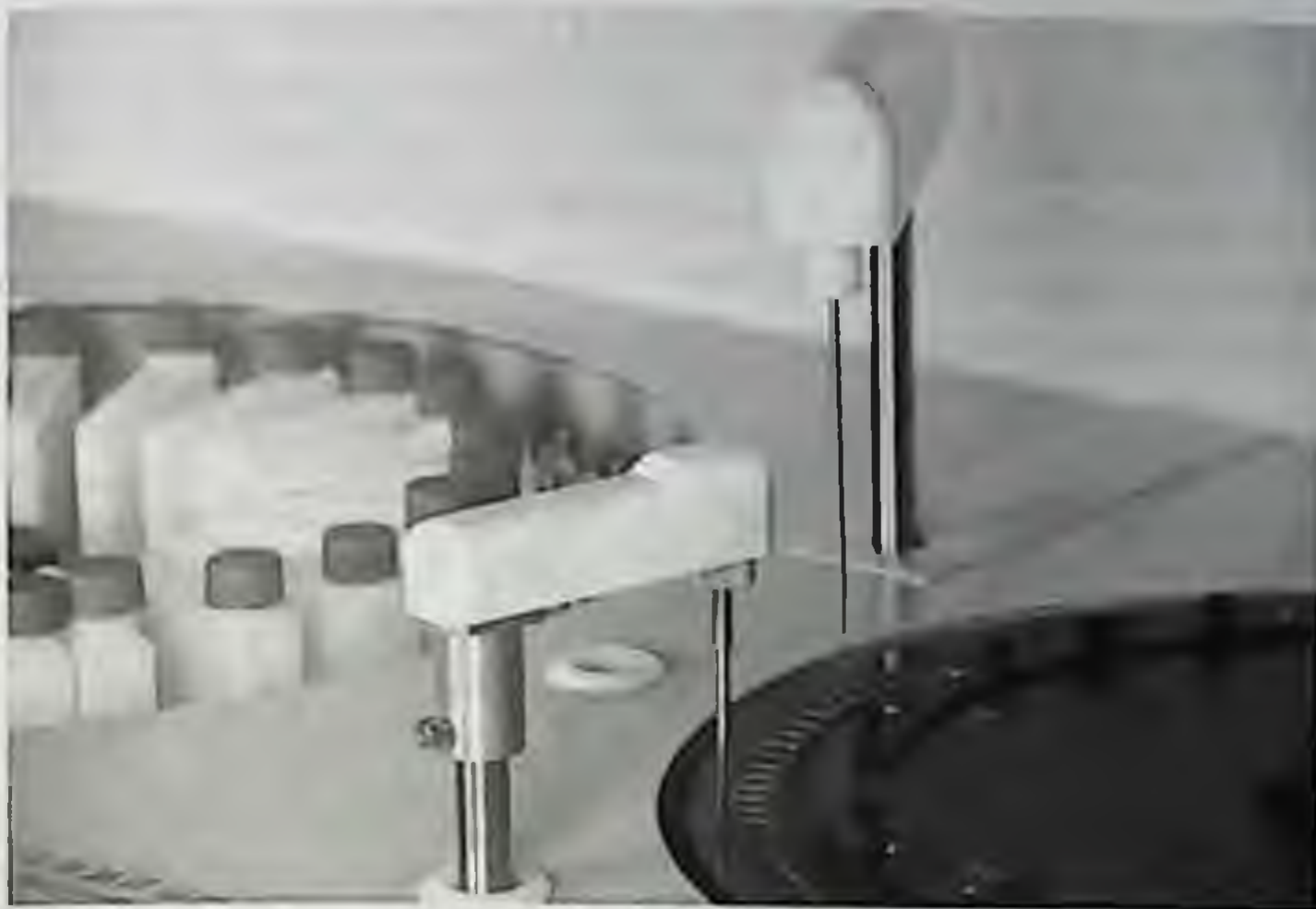
Рис. 12.62. Многоходовый реакционный ротор биохимического анализатора
