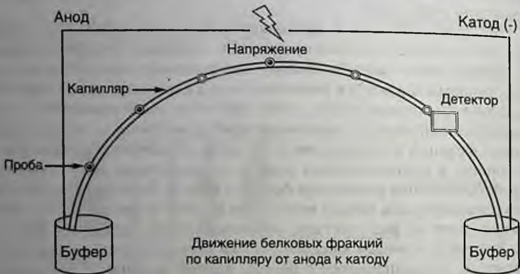
Рис. 12.5. Проведение капиллярного электрофореза белков сыворотки крови
