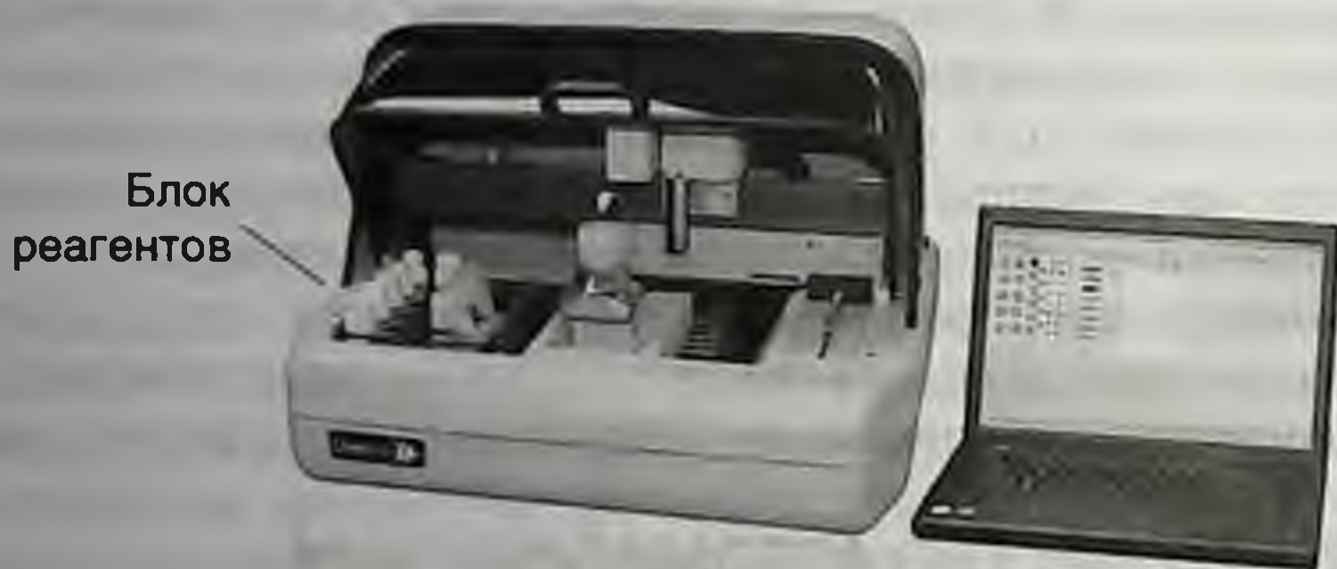
Рис. 12.61. Линейный реагентный блок
