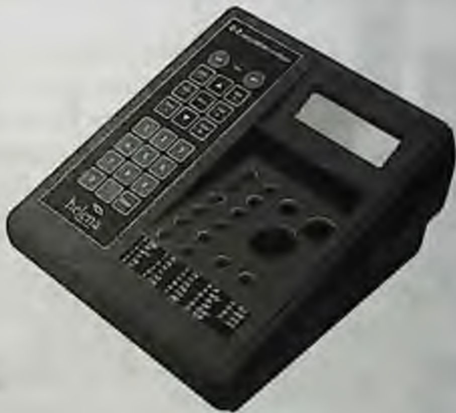
Рис. 13.7. Двухканальный полуавтоматический коагулометр
