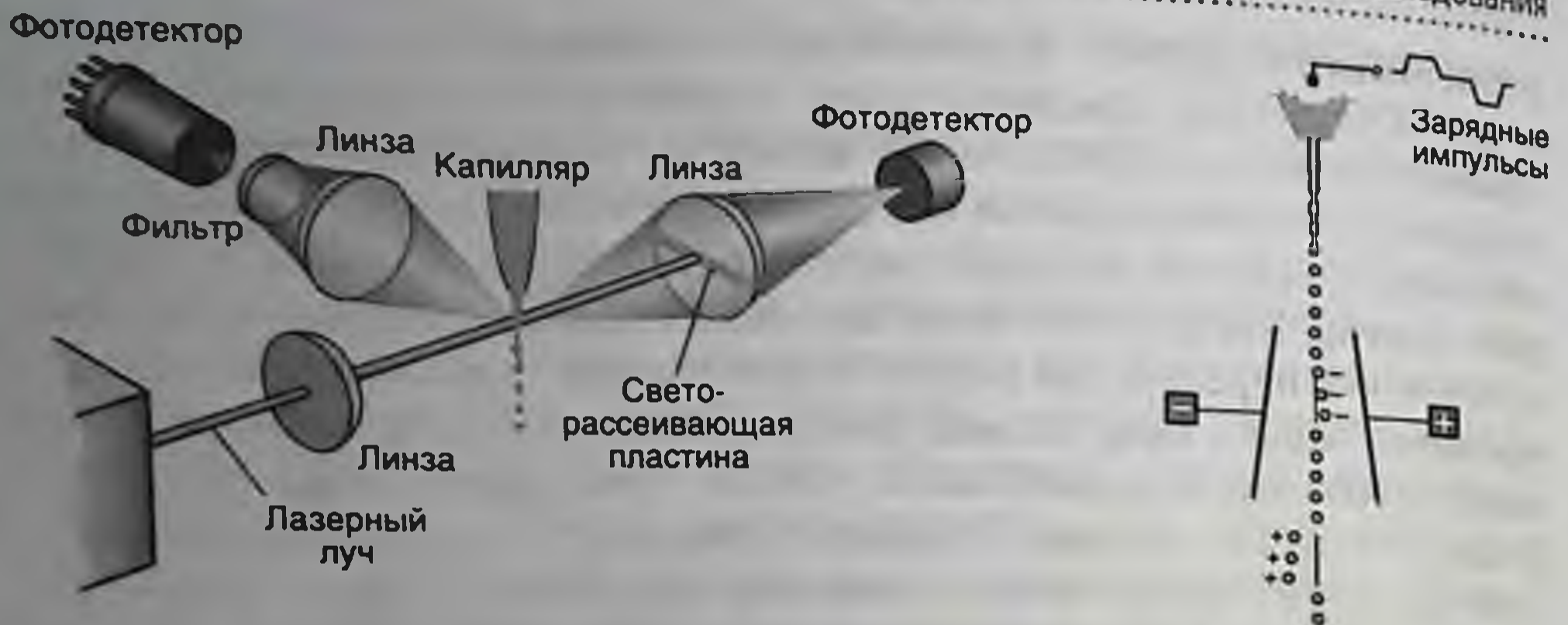
Рис. 14.1. Принцип работы проточного цитометра
