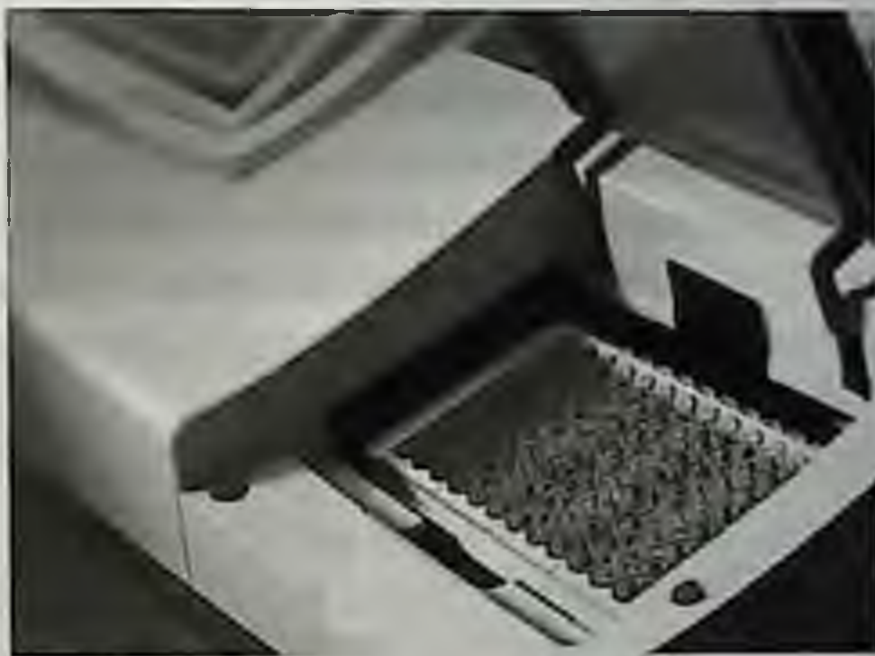
Рис. 18.27. Тест-панель, помещенная в полуавтоматический анализатор для считывания результатов
