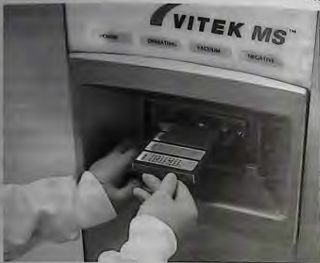
Рис. 18.29. Помещение подготовленных проб в масс-спектрометр для анализа
