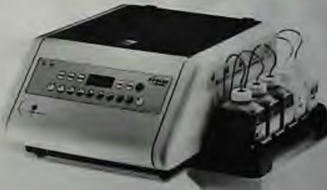
Рис. 18.8. Автоматизированная система PREVI Color Gram
