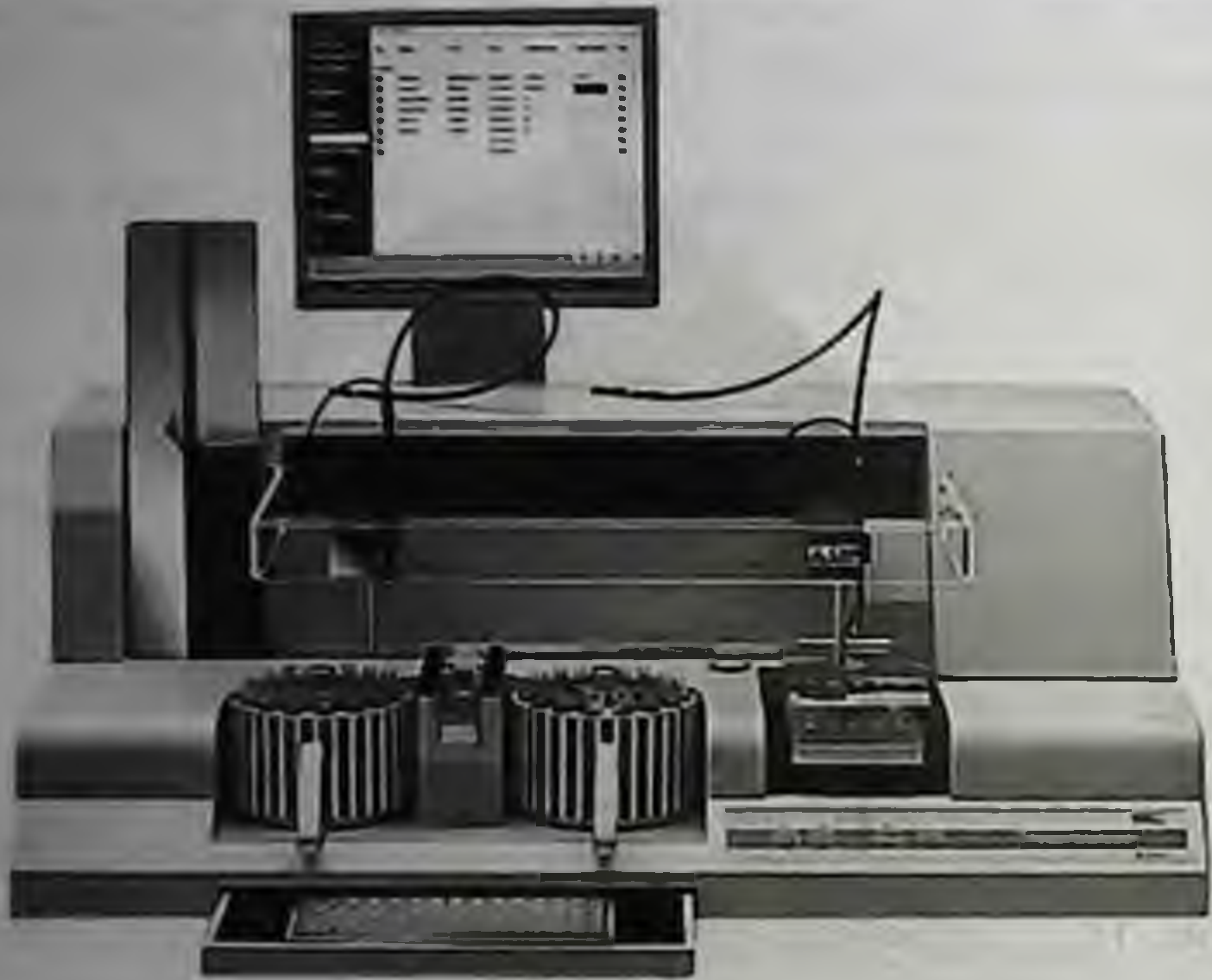
Рис. 13.8. Четырехканальный автоматический коагулометр
