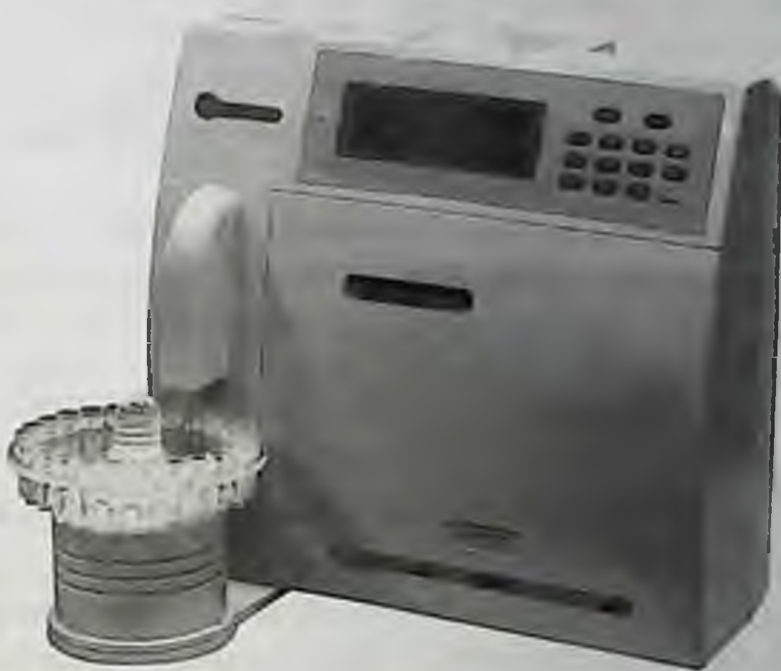
Рис. 12.43. Ионоселективный анализатор с устройством для автоматической подачи проб
