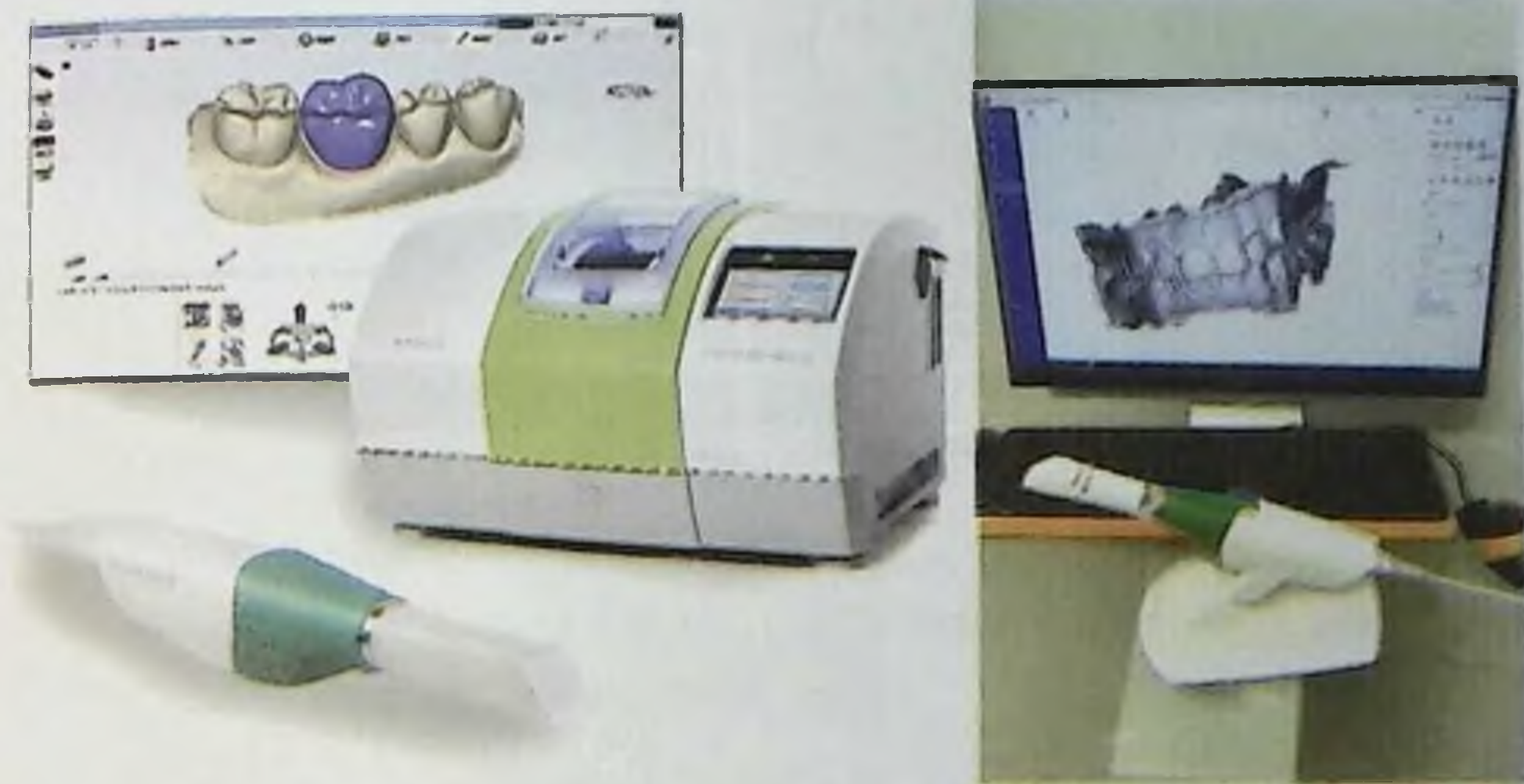
Рисунок 6.7. Сканер Planmеса Emerald является частью Planmеса FIT, стоматологической CAD/CAM системы
