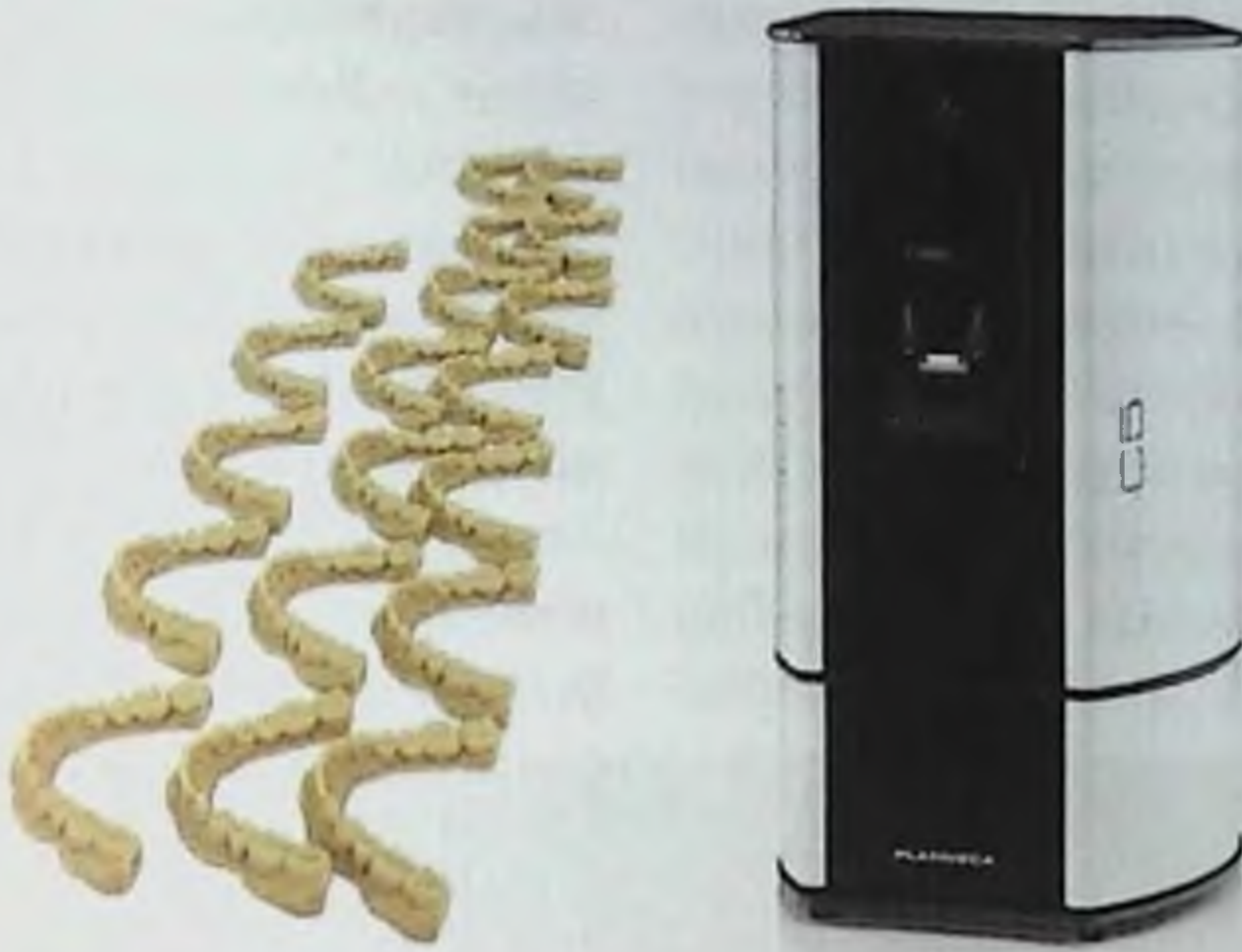
Рисунок 6.14. Серия переходных моделей автоматически создана с помощью программного обеспечения Romexis Ortho Studio, а затем экспортирована для 3D печати в формате STL.
