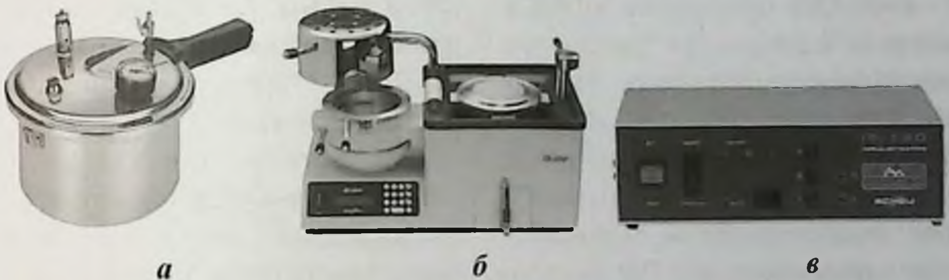
Рисунок 1.4. Полимеризатор (а), аппарат «Министар» для изготовления штампованных ортодонтических аппаратов (б), аппарат точечной сварки фирмы «Шой-Дентал» «IP-120» (в)
