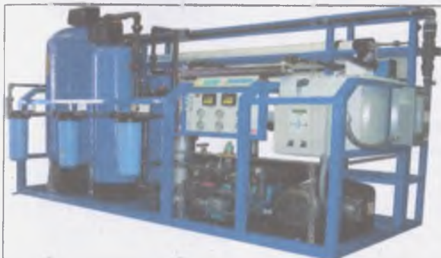
7-rasm . 1 soatda 3 kg gacha xlor sarflaydigan qurilma.
