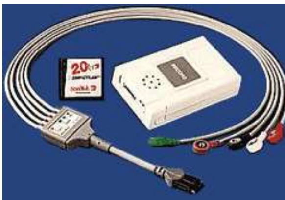
Рис. 2.23. Общий вид приспособления «PC Card Recorder 92514» ведущий мониторинга ЭКГ по хольтеру
