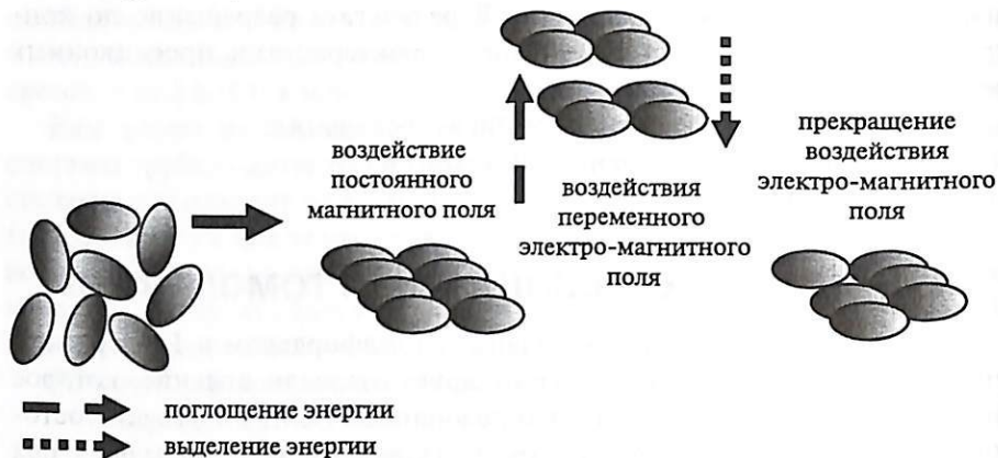
Рис. 18. Схема физического принципа МРТ
