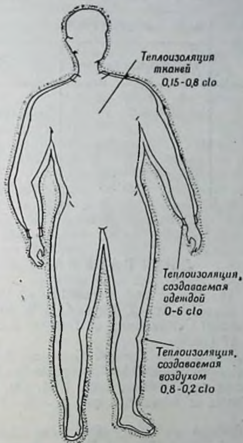
Фиг. 23. Различные виды теплоизоляции, составляющие общую теплоизоляцию человека, и амплитуда их колебаний [18].
