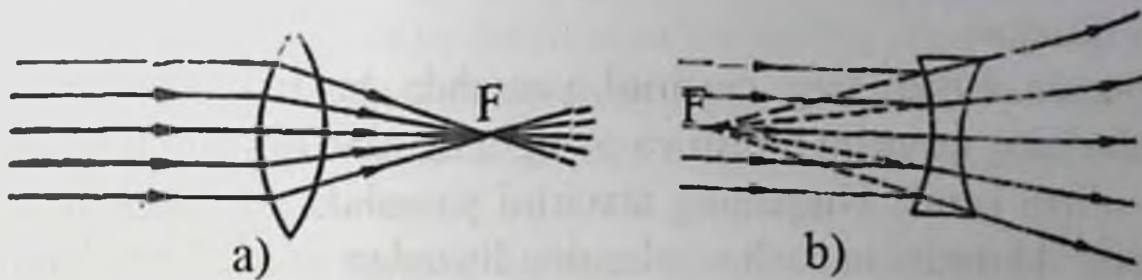
7.8-rasm. Linzada bosh va qo'shimcha optik o'qlardan o'tuvchi nurlarning yo'li
