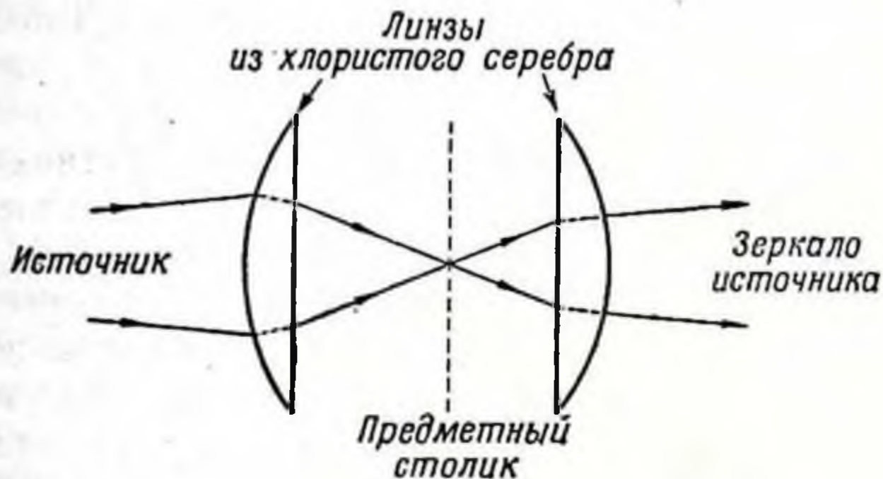
Ф и г. 4. Схема конденсора из хлористого серебра (сечение вдоль оптической оси).
