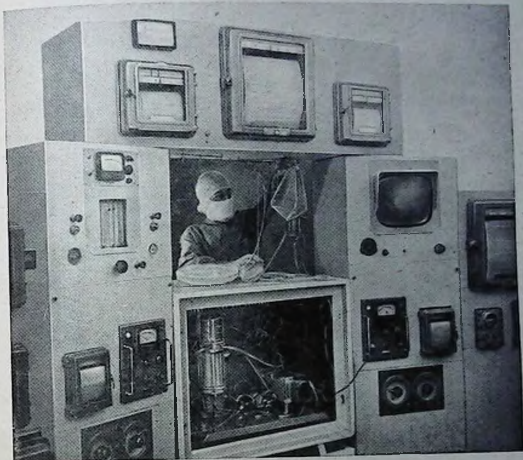
Рис. 72. Установка для управляемого культивирования изолированных органов «Гомеостат-1» ИФ СО АН СССР.
