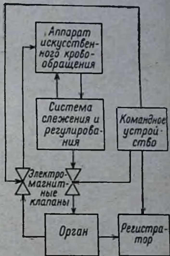
Рис. 47. Блок-схема измерения КСП O_2 .
